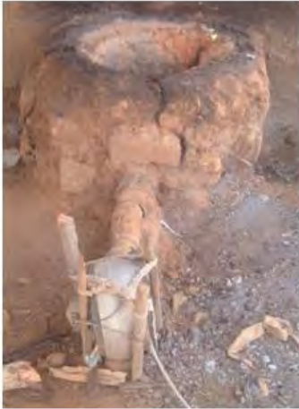
Bobine reliée au foyer par un conduit
